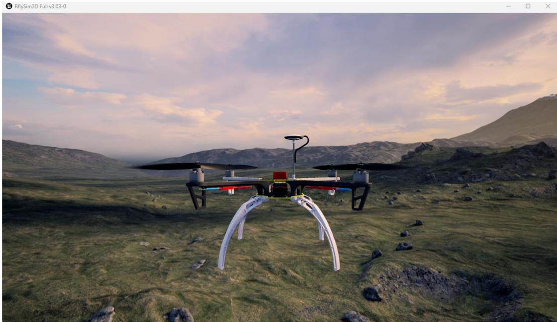
重新将 CH5 拨到最高，Simulink 拿回控制权，上推油门使得飞机悬停。
