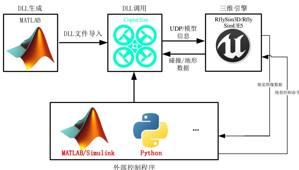
CopterSim 会根据从 Pixhawk (或者 PX4 SITL) 传入的电机控制数据解算出无人机当前的状态 (主要是位置、姿态数据)，随后会将这些数据发送给 RflySim3D，而 RflySim3D 会将这些数据应用至场景里相应的无人机上，从而使我们能更直观的看到无人机的状态。
