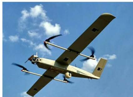
(g)固定翼多旋翼复合型
