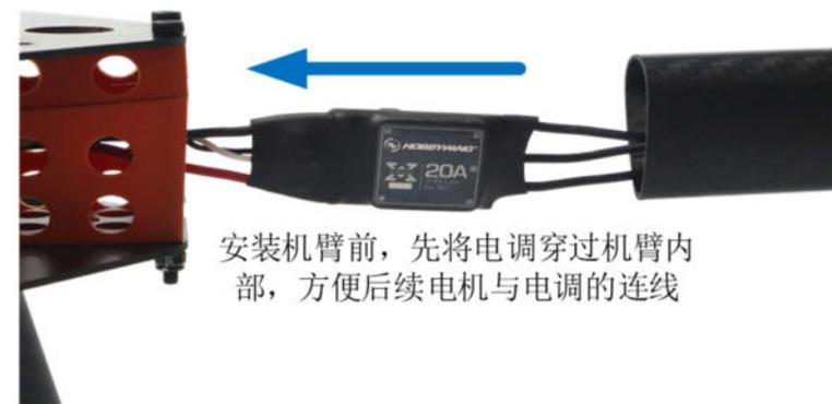
安装机臂前，先将电调穿过机臂内部，方便后续电机与电调的连线
