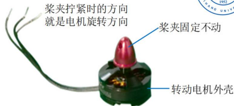
电机旋转方向的确认
