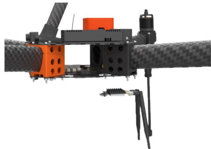
数传电台机载端的连接
