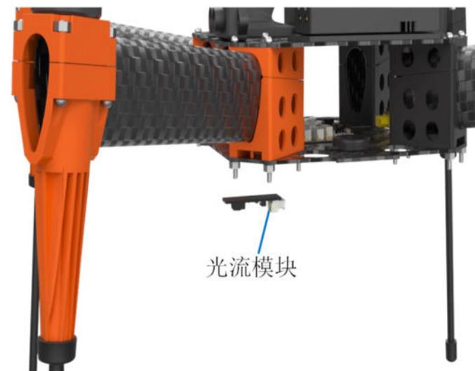
光流模块的安装仿真图示
