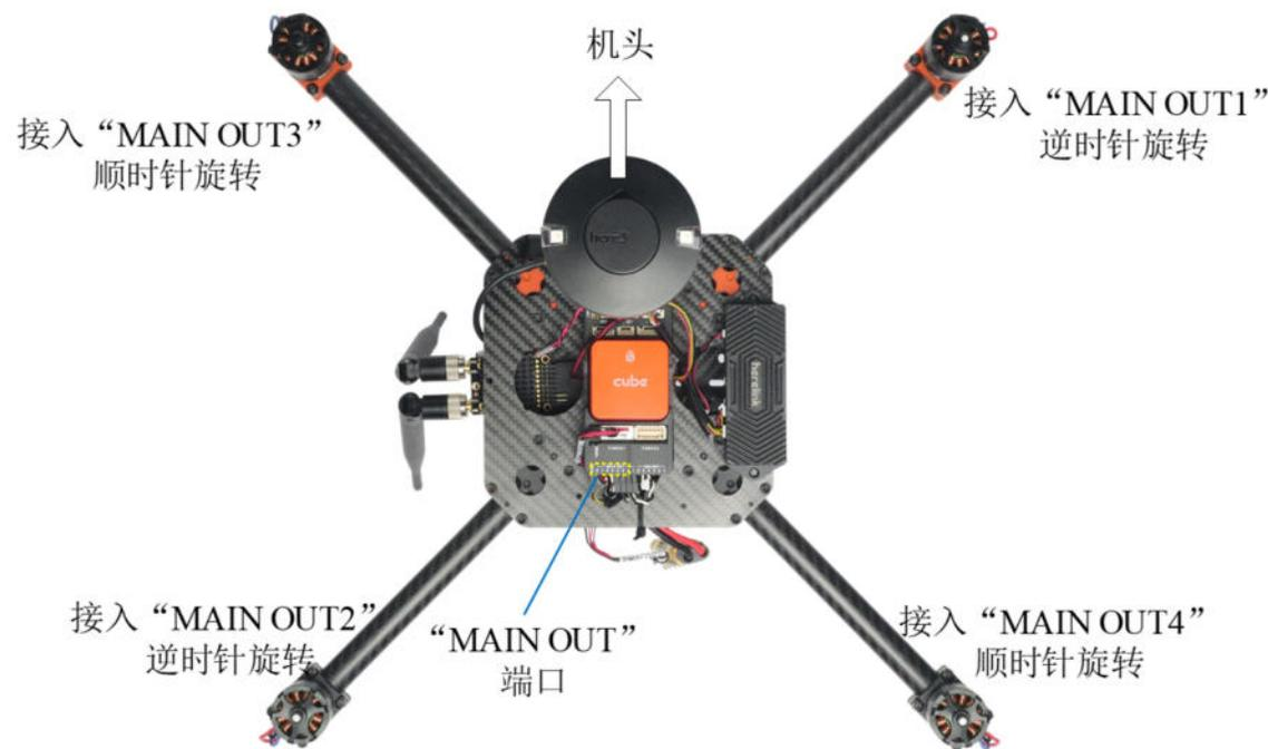
电机旋转方向的定义
