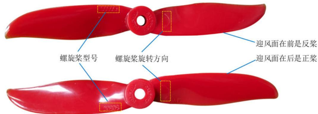
螺旋桨旋转方向的确认
