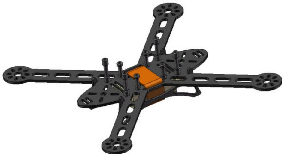
金属支柱安装完成示意图
