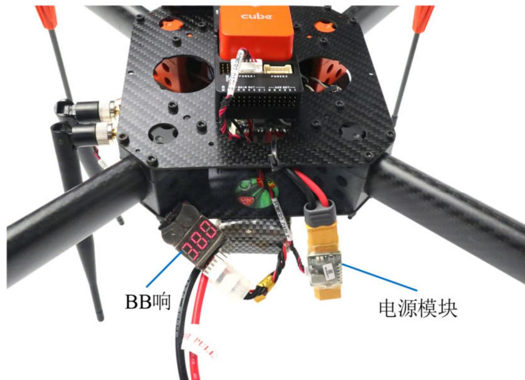
电源模块的安装
