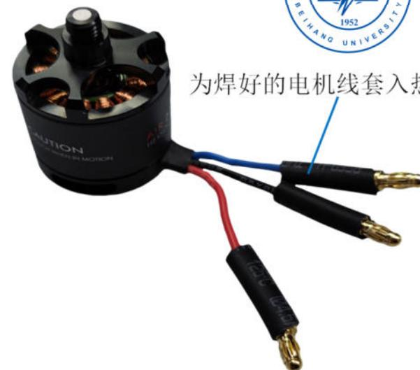
为焊好的电机线套入热缩管
