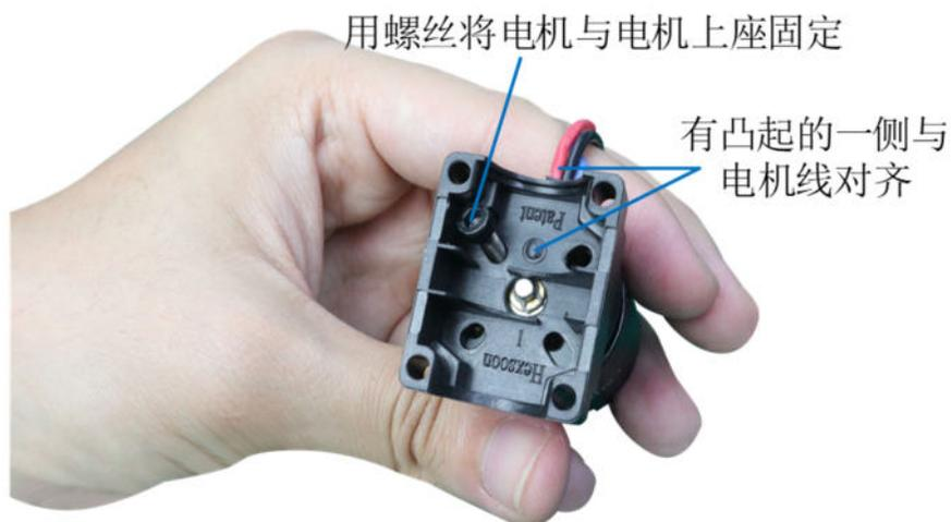
电机与电机上座的安装固定
