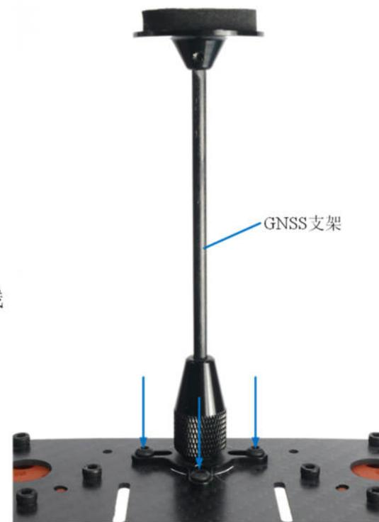
GNSS支架的安装
