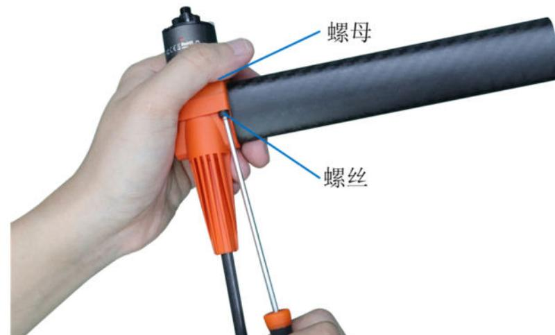
电机座与机臂的安装固定
