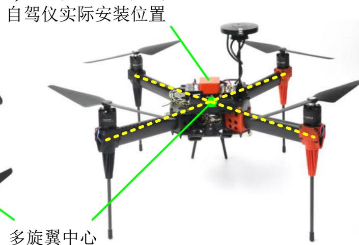
Pixhawk/APM2自驾仪可在超过30度角的方位安装在机架上，可通过相应的软件设置重新得到自驾仪安装在机体上的标准方位。
