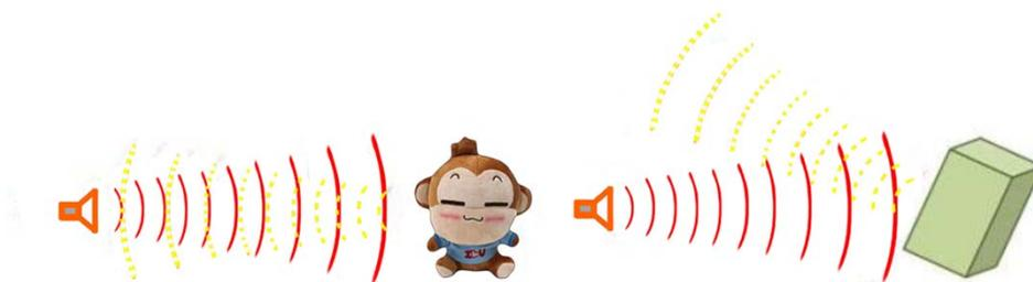
图7.13 超声波测距失效情形
