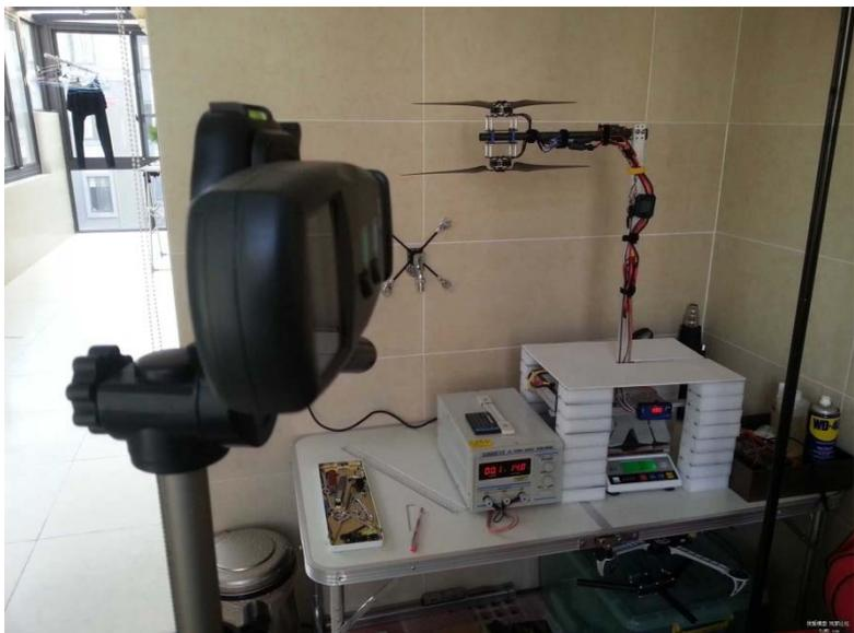
图 6.14 网友DIY动力系统测量装置<sup>1</sup>
