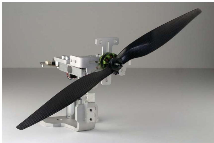
图 6.15 专业动力系统测量装置RCbenchmark-1580<sup>2</sup>
