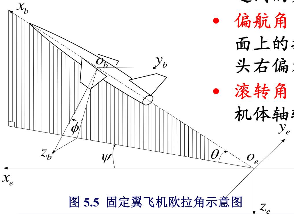
图 5.5 固定翼飞机欧拉角示意图
