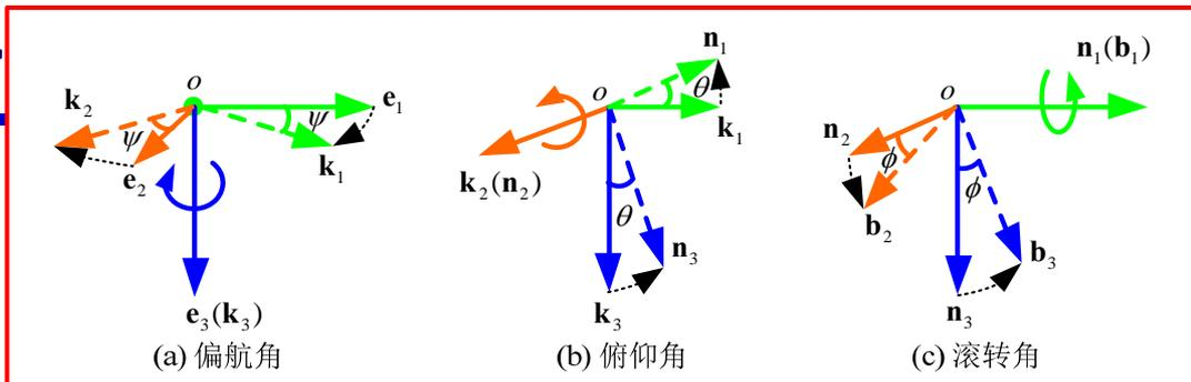
从地球固联坐标系到机体坐标系的旋转可以通过三步来完成
