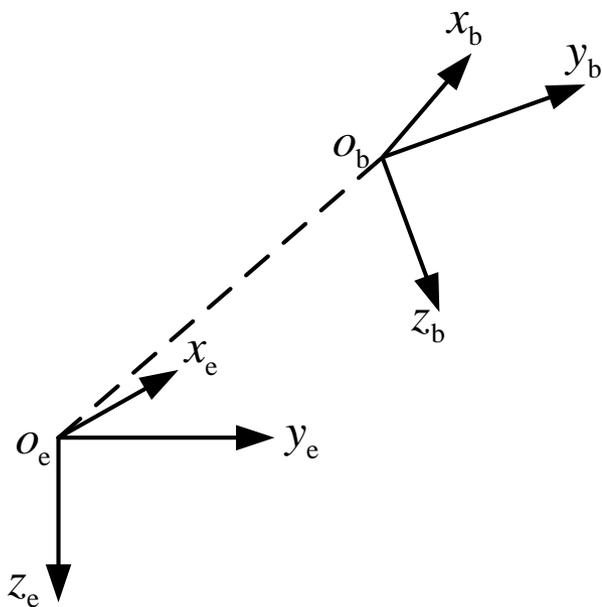
图 5.2 机体坐标系与地面坐标系的关系图
