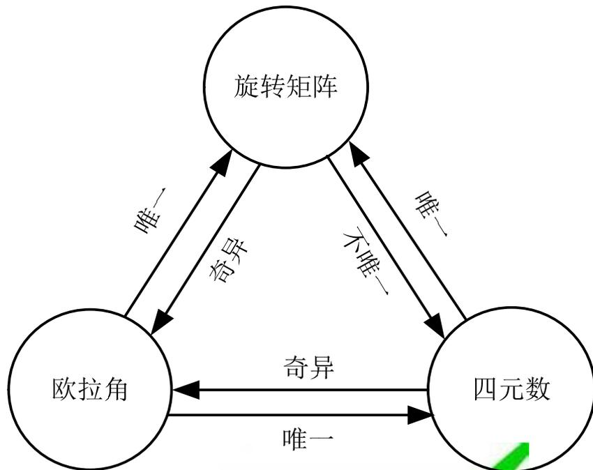
图 5.10 三种旋转表示法之间的相互转换
