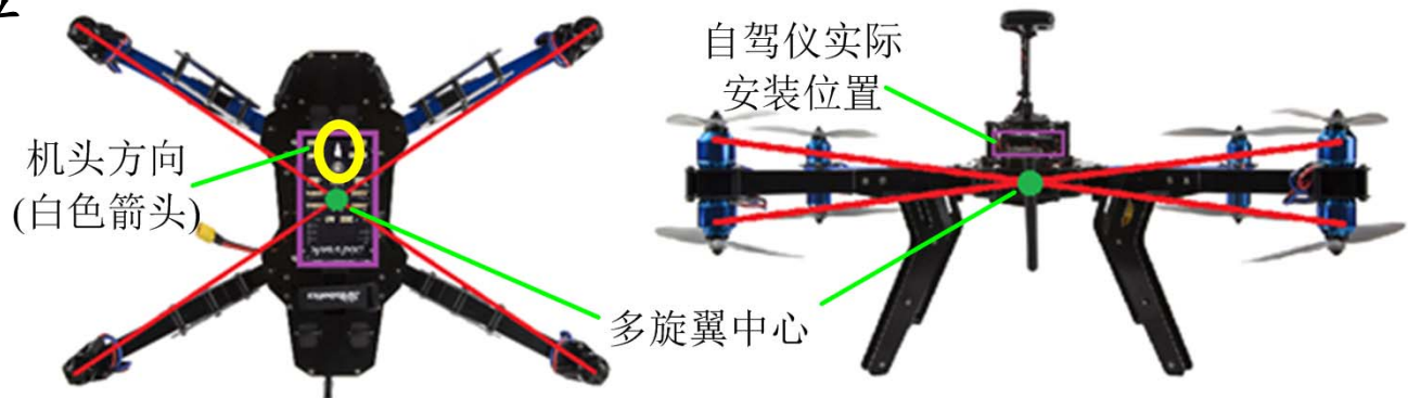
图3.11: 飞控板安装位置
