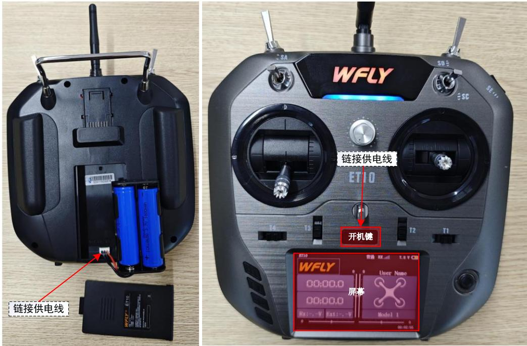
正常点亮后，拨动(或按动)遥控器正面的所有拨杆、按钮等，是否可以有卡顿或不灵活情况。检查无误后，通过数据线对无人机进行供电，同时使无人机连接 QGroundControl 地面站，无人机与遥控器已经进行过配对。
