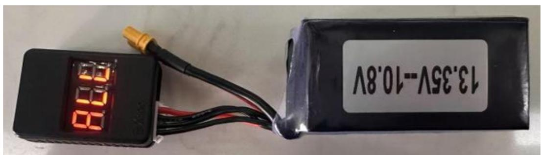
在听到两声滴滴声后，说明 BB 响与电池之间正确连接并开始工作，之后，在 BB 响的显示屏上会循环显示电池当前的总电压以及每一节电芯当前的电压。
