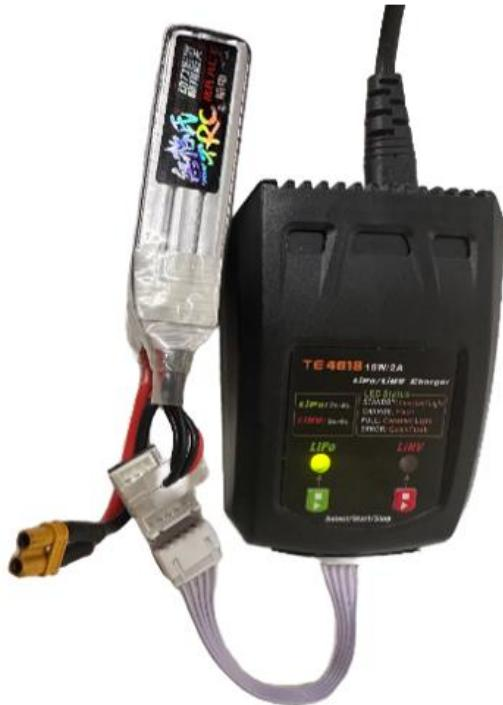
之后，电机 Lipo 下方的按键，当绿灯开始闪烁时，说明电池开始充电。当需要暂停充电时，同样点击该按键，当绿灯停止闪烁后，说明充电停止。同样，当绿灯自动停止闪烁时，说明电池电量充满。电池充满电的过程大约需要一个小时，在充电的过程中，需要时刻有人在旁边关注，在电池充满电之后，需要及时对充电器进行断电。
