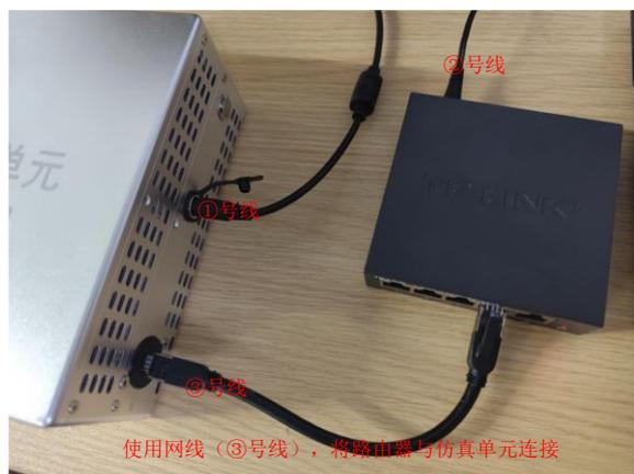
图 11 集群控制仿真单元连接路由器
