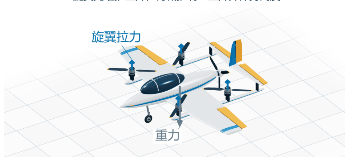
图：过渡中旋翼与机翼共同承载
