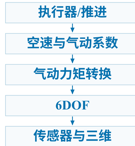
图：固定翼模型中的方程职责
