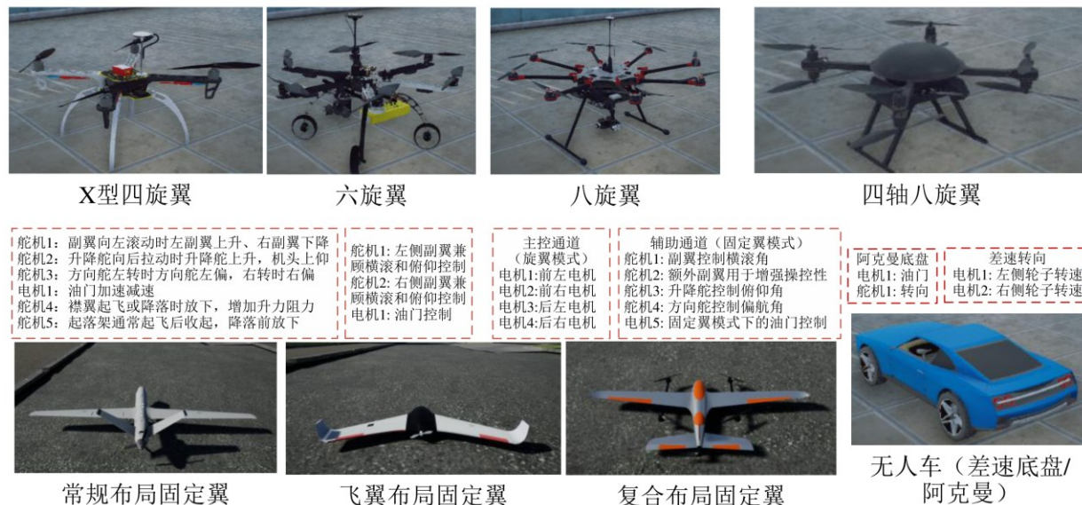
图4.14 不同无人载具的控制通道
