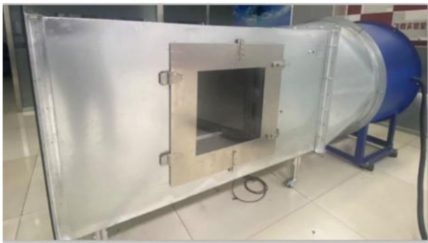
(c) 无人机风洞测试设备
