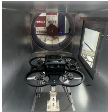
(d) 风洞内部安装图
