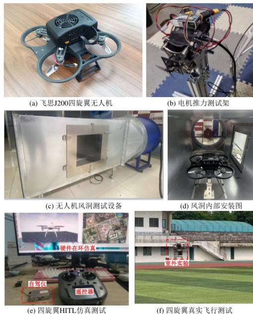
图4.13 基于RflySim的无人机系统辨识软硬件平台
