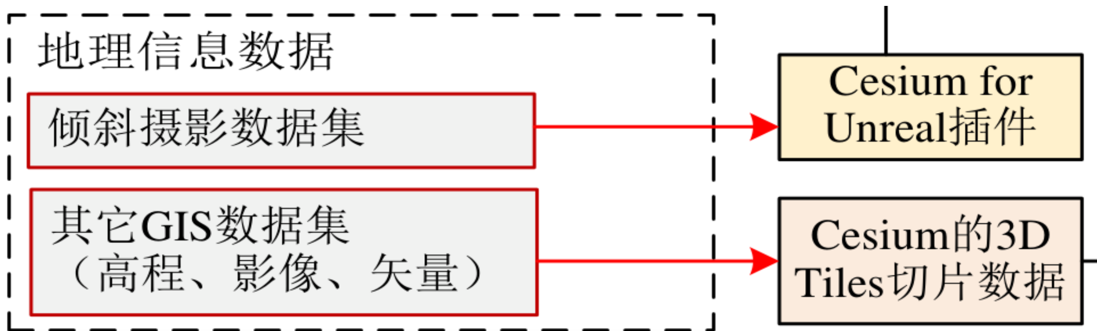
图3.7（地理数据局部）：OSGB与高程、影像经切片工具形成可加载资源。
