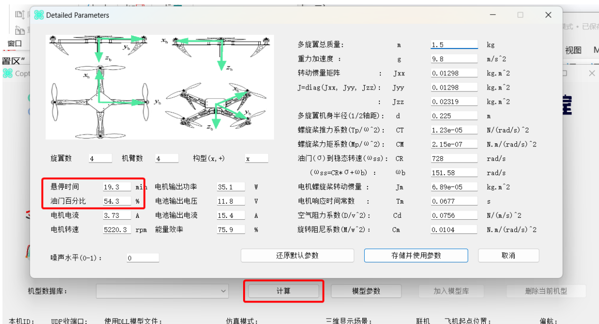
图：e1_CopterSim-Usage中的详细参数计算，红框为悬停结果
