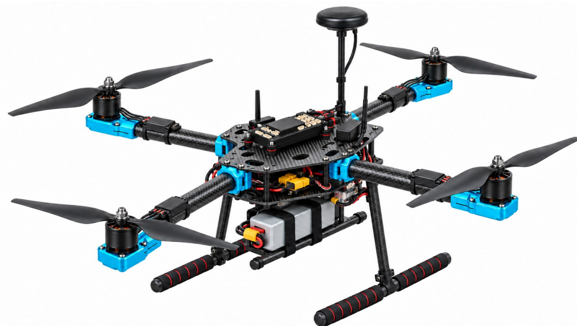
图：完成无桨验证后的装桨示意图
