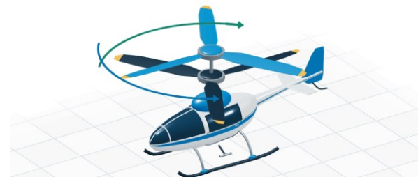
共轴双旋翼：反向旋转、转矩平衡
