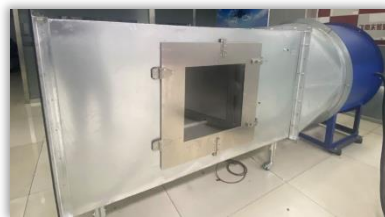
图 2 风洞外部结构
