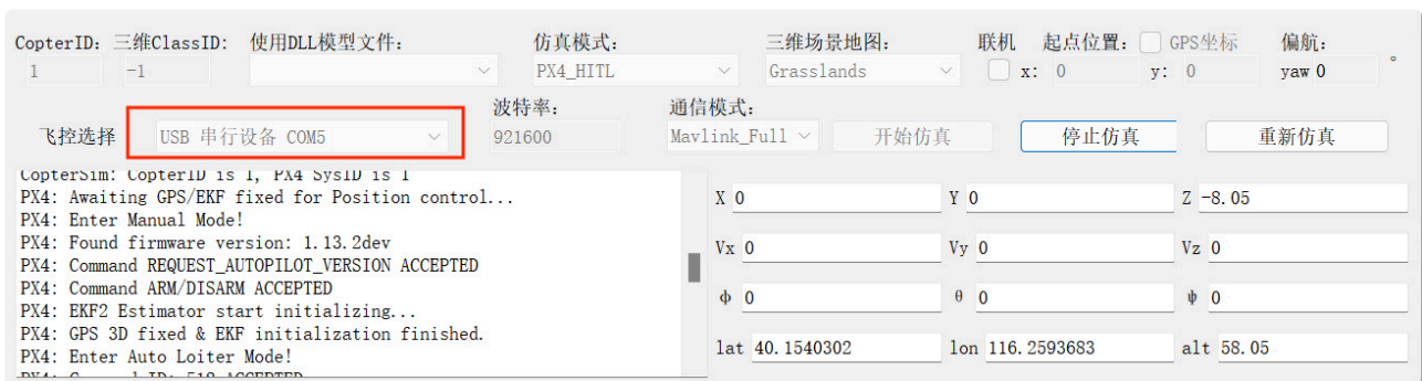
图 8 CopterSim连接飞控串口信息
