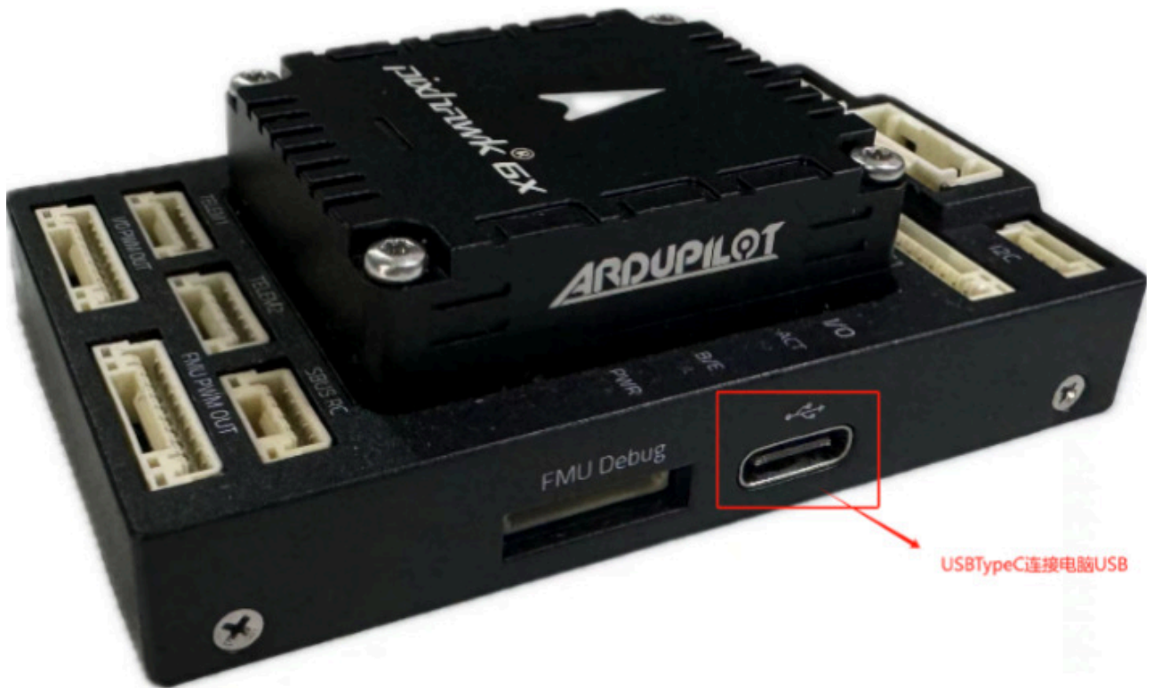
图 6 飞控USB口示意图（Pixhawk 6x为例）
