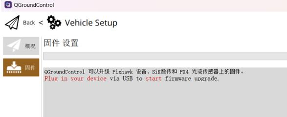
之后使用数据线连接 150 飞行器，会弹出固件烧录弹窗，选择高级设置中的自定义固件。
