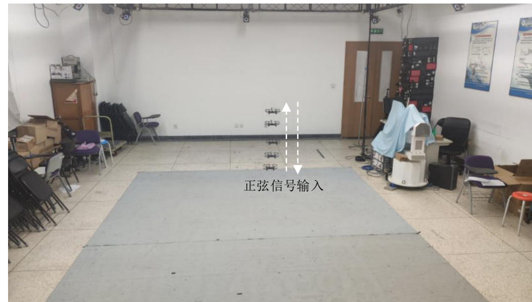
图. 实飞实验高度通道卡尔曼滤波器实飞图（影像进行了叠加）
