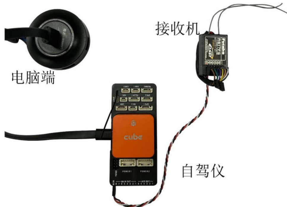
接收机供电接线图
