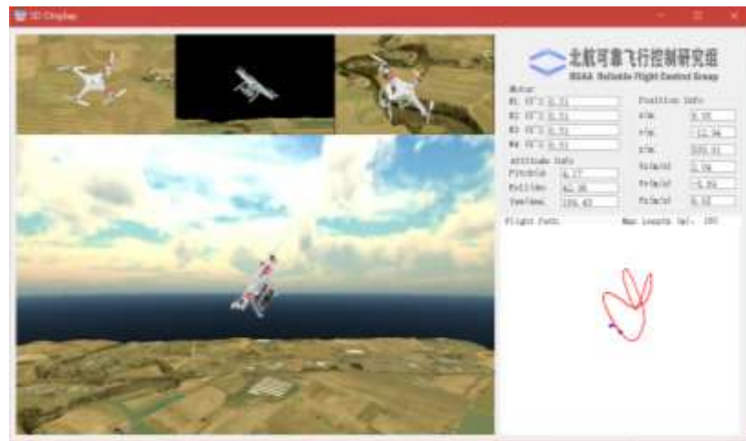
图. 拨动摇杆使四旋翼无人机滚转角变化
