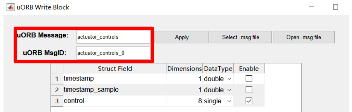
(b) uORB Write Advanced_dai模块，消息ID可以设置与.msg文件名不同
