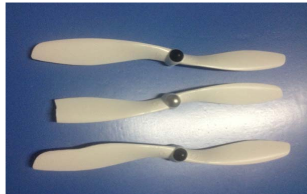
图14.2 桨叶形状（自上至下依次为：正常桨叶，断桨桨叶，切削桨叶）
