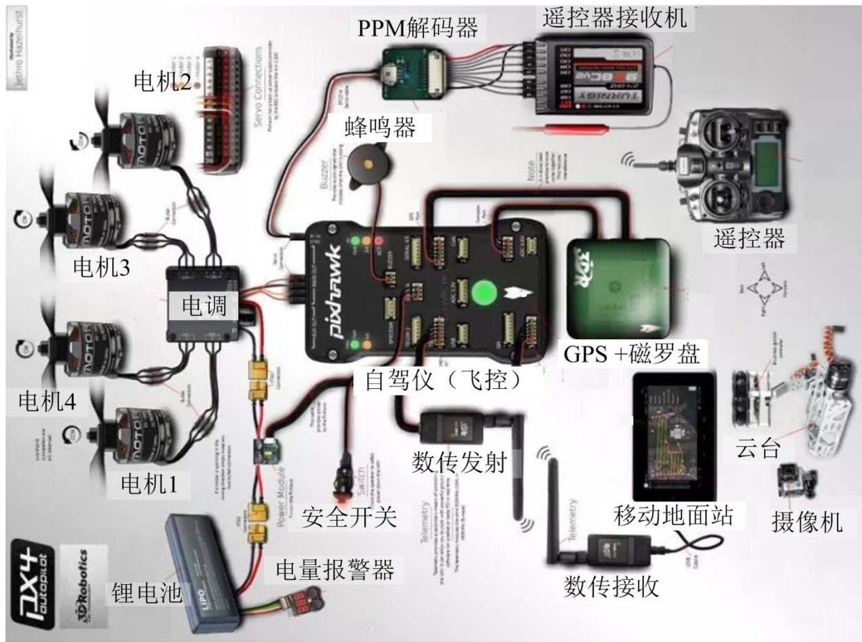
图2.2:多旋翼内部布局, 图片主体来源于网站 [ardupilot.org](http://ardupilot.org)
