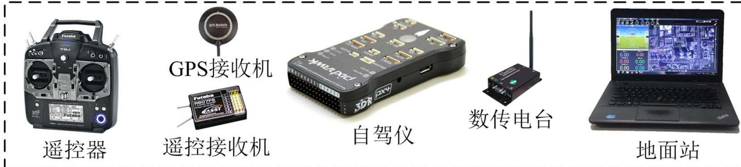
图2.1:多旋翼系统实物图
